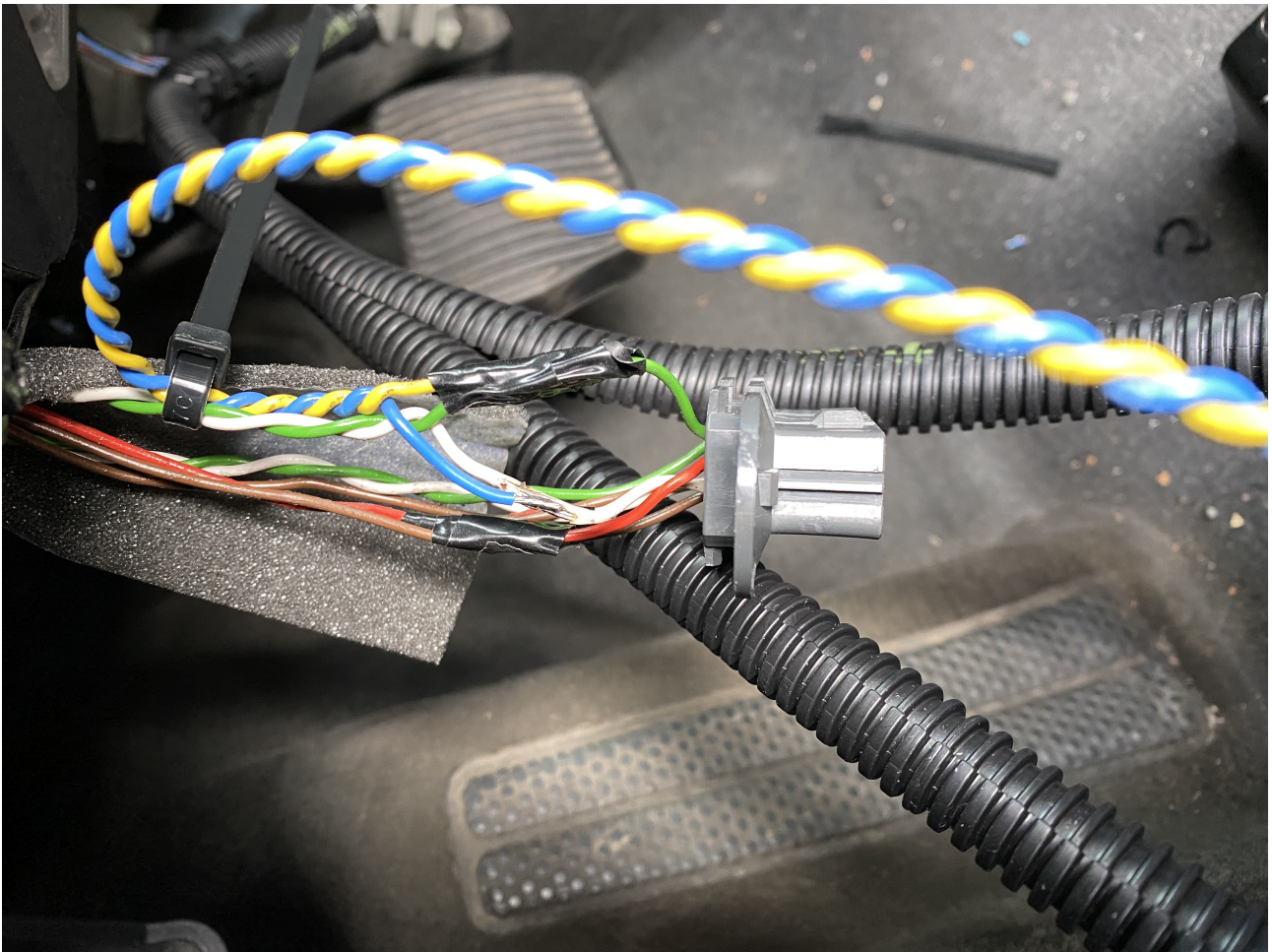
Bild visar inkoppling av canbus signaler till H-CAN. Canbus signalerna är tagna genom inlödning bakom OBD-port stift 6 och 14.
