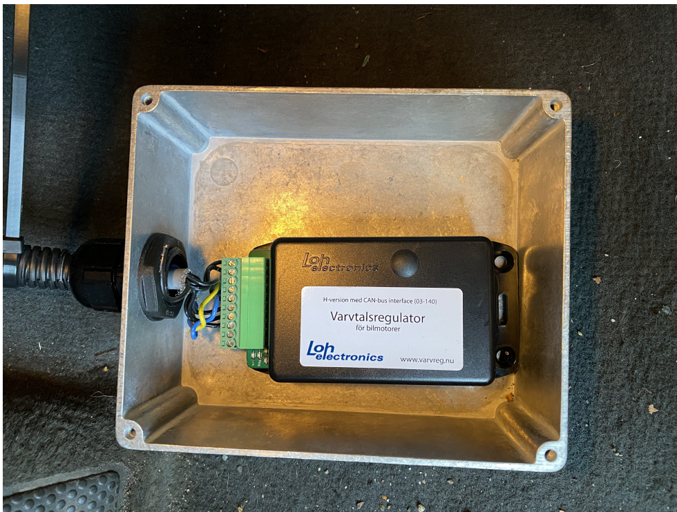
Bild visar inkopplingslåda med Loh Electronics AB Varvtalsregulator H-CAN.
