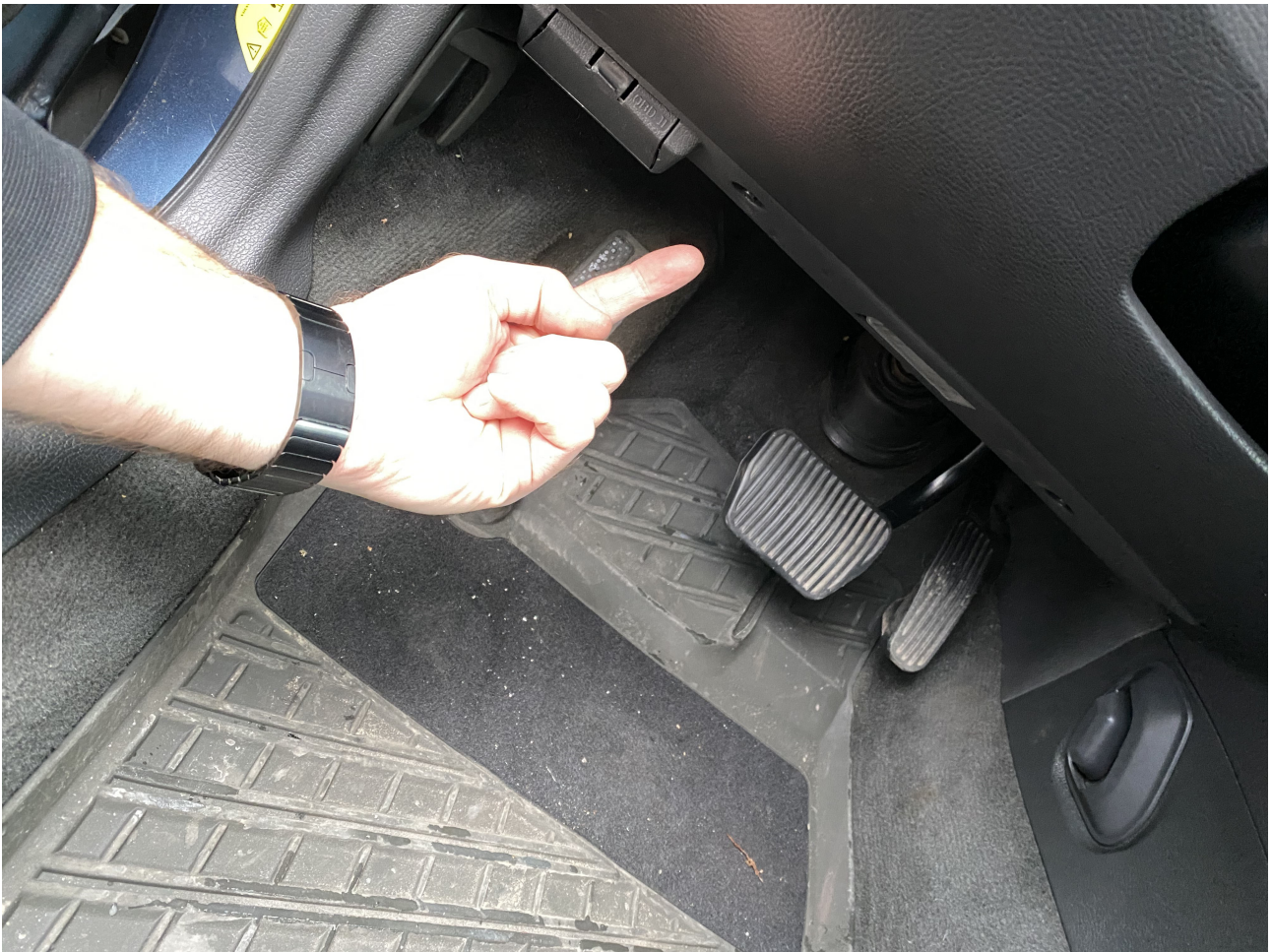
Bild visar monteringsdosans placering i bilen, till vänster under ratten.
