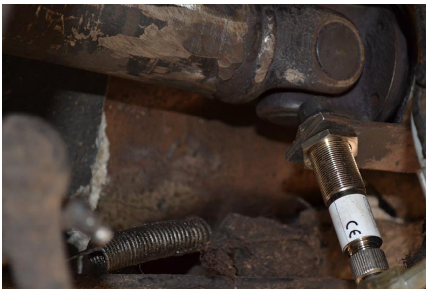
Illustration 1: Induktiv sensor mäter hastighet genom att mäta kardanaxelns varvtal.
